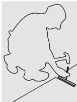
**Inserimento del connettore di coda nell'incavo.**
